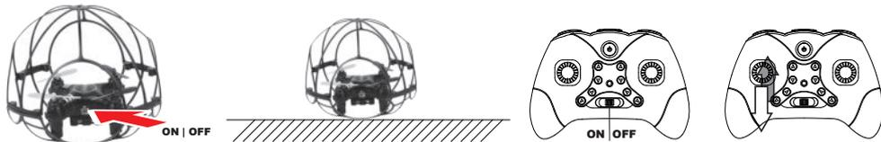
Modell einschalten (ON/OFF), die LEDs blinken - Drohne waagrecht abstellen - Fernsteuerung einschalten
