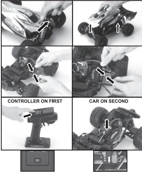
Um den Akku zu entnehmen/ einzusetzen oder das Modell ein-/ ausschalten müssen Sie die Karosserie abnehmen. Entfernen Sie die Karosserieklammern und heben die Karosserie vom Fahrzeug ab.
