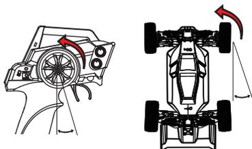
Durch drehen am Lenkrad nach links lenkt das Modell nach links.
