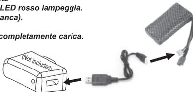
Cargue SIEMPRE la batería fuera del modelo, para evitar el sobrecalentamiento durante la carga, utilice siempre una base ignifuga!
