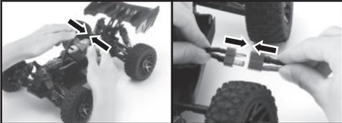
Pour retirer/installer la batterie ou allumer/éteindre le modèle, vous devez retirer la carrosserie. Retirez les clips de la carrosserie et soulevez la carrosserie du véhicule.
