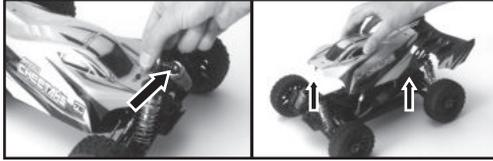
Um den Akku zu entnehmen/ einzusetzen oder das Modell ein-/ ausschalten müssen Sie die Karosserie abnehmen. Entfernen Sie die Karosserieklammern und heben die Karosserie vom Fahrzeug ab.
