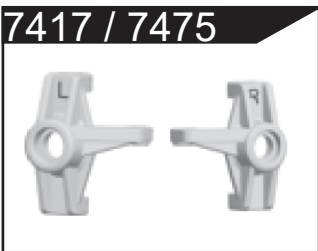
Lenkhebel vorne (2) 7417 - Kunststoff 7475 - Metall
